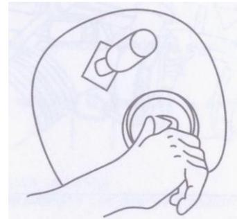
11. Wenn möglich, die Motorkurbelwelle 10-15 Sekunden lang drehen, ohne sie zu starten oder den Motor einige Sekunden lang zu starten, um die Rohre und den Turbolader selbst vollständig mit Öl zu füllen und zu entlüften.
